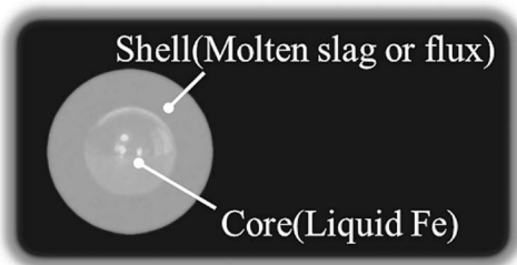
図3 国際宇宙ステーション(ISS)における液滴振動法による溶鉄-溶融スラグ・フラックス間の界面張力測定用コア-シェル型の2重層液滴試料。
