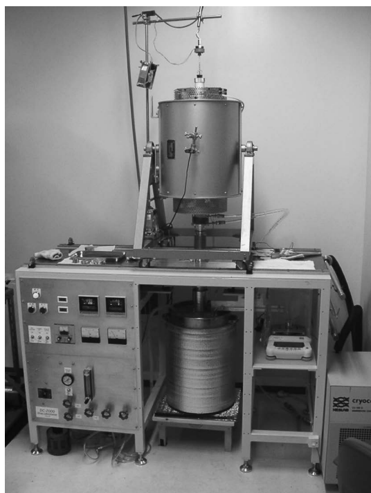
図1 加熱炉と水熱量計を組み合わせた落下型熱量計。
