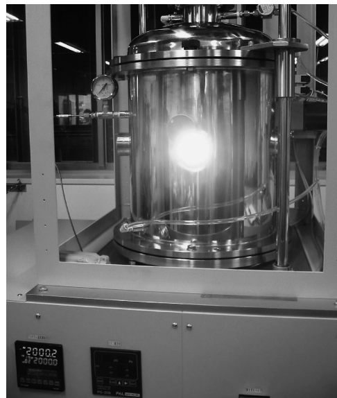
図2 融体滴下機構を備えた超高温濡れ性評価装置の外観(最高評価温度2000°C).
