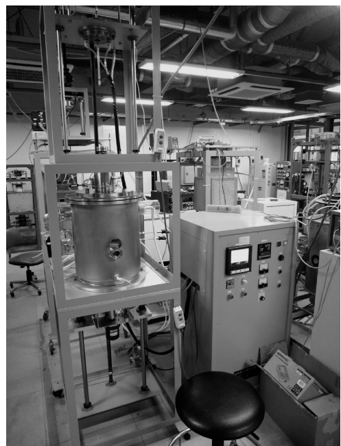
図4 酸化剤融体の粘度および結晶化挙動同時評価装置の外観(最高測定温度1600°C)。
