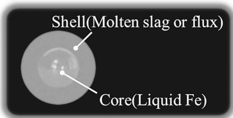
図3 国際宇宙ステーション(ISS)における液滴振動法による溶鉄-溶融スラグ・フラックス間の界面張力測定用コア-シェル型の2重層液滴試料。
