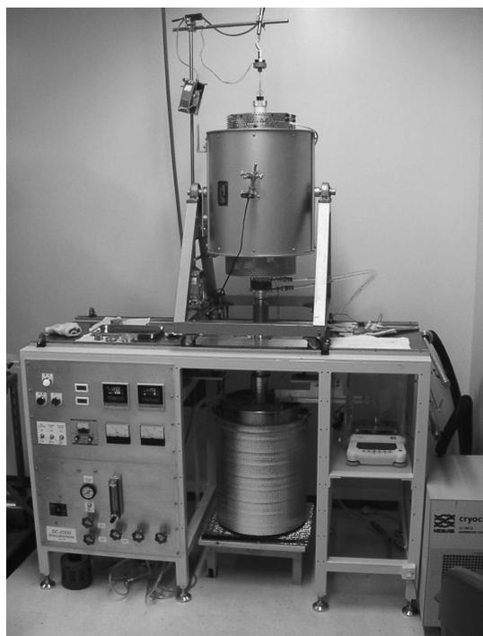
図1 加熱炉と水熱量計を組み合わせた落下型熱量計。
