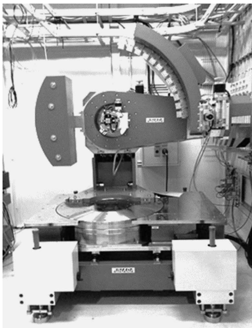
図1.2 SPring-8 BL19B2に設置されている回折装置．散乱X線パターンは弧状に配置された1次元半導体検出器で測定される．試料交換，試料位置調整，散乱パターン計測の一連の測定作業が連続的に全自動で行われる．
