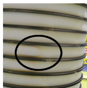
図4 変色した碍子： ○の部分に顕著に変色。
