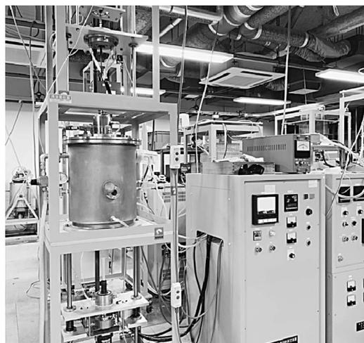
図1 粘度・電気容量同時測定装置。
