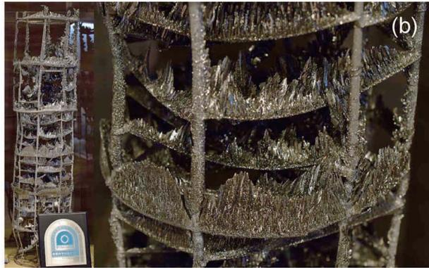
元素名：Titanium，原子番号：22，質量数：47.87，電子配置：[Ar]3d<sup>2</sup> 4s<sup>2</sup>，密度：4.508 Mg·m<sup>-3</sup>(298 K)，結晶構造： $\alpha$ -Ti 六方晶 (~1156 K)， $\beta$ -Ti 立方晶 (1156~1953 K)，融点：1953 K，沸点：3535 K，地殻存在量 0.7 mass%-TiO<sub>2</sub>【写真】(a)クロール法により得られたスポンジチタン(日本金属学会 写真提供)，(b)TiCl<sub>4</sub> 蒸気を Mg 蒸気で還元して得られたチタン(東北大学金属材料研究所 写真提供，参照：竹内ら，日本金属学会誌，23(1959)，629-633.)
