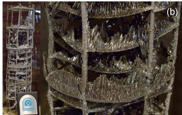
元素名：Titanium, 原子番号：22, 質量数：47.87, 電子配置：[Ar]3d2 4s2, 密度：4.508 Mg·m<sup>-3</sup>(298 K), 結晶構造： $\alpha$ -Ti 六方晶(～1156 K),  $\beta$ -Ti 立方晶(1156～1953 K), 融点：1953 K, 沸点：3535 K, 地殻存在量0.7 mass%-TiO<sub>2</sub>【写真】(a)クロール法により得られたスポンジチタン(日本金属学会写真提供), (b)TiCl<sub>4</sub>蒸気をMg蒸気で還元して得られたチタン(東北大学金属材料研究所写真提供, 参照:竹内ら, 日本金属学会誌, 23(1959), 629-633.)
