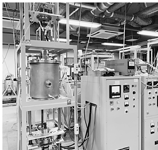
図1 粘度・電気容量同時測定装置。
