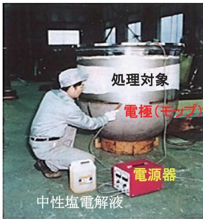
図1 電解法による焼け取り作業状況。
