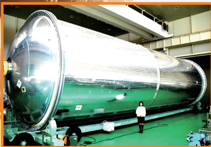
H-IIロケットの第1段液体水素タンク ©JAXA
