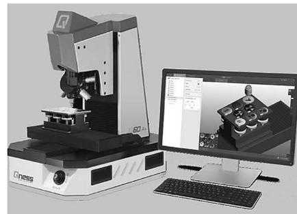
Q30A+は、ピッカース、ヌーブおよびブリネルの硬さ試験ができる、汎用性の高いマイクロ硬さ試験機です。試験荷重は0.25g～31.25kg(0.25g～100gはオプション設定)をカバーします。工程を制御するソフトウェアQpix Control2は、直観的、体系的に設計されておりプロフェッショナル向けに構成されています。例えば、試験ヘッドの自動高さ調整、非接触測定、独自のサンプル・ホルダーの認識、そして試験環境を容易に理解できる3D制御原理と視野角度の制御などがあります。
