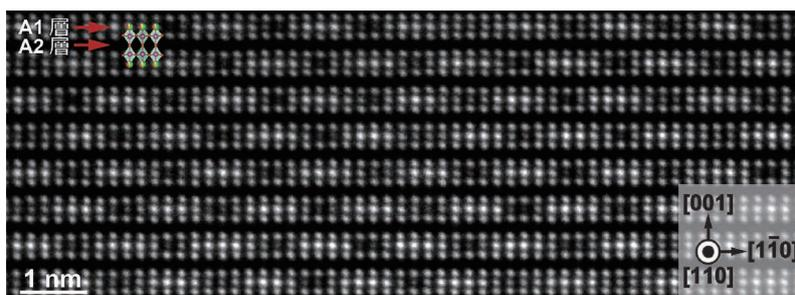
図2 (La,Li)NbO<sub>3</sub> 変調構造の HAADF STEM 像。
