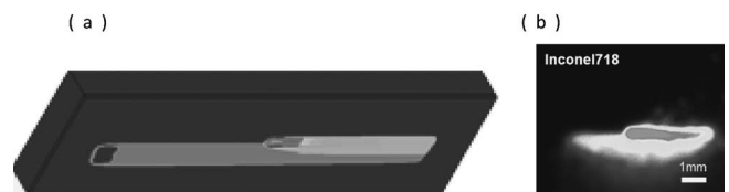
図 5 新たなモデルを利用したマクロ熔融凝固シミュレーション結果とサーモビューワによる測定結果の比較 (7) ；(a)シミュレーション結果 (b)測定結果。
