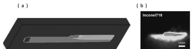
図 5 新たなモデルを利用したマクロ熔融凝固シミュレーション結果とサーモビューワによる測定結果の比較<sup>(7)</sup>；(a)シミュレーション結果 (b)測定結果。
