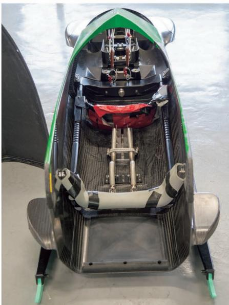
（左）ボブスレーを後ろから見たところ。手前の底部の四角い枠に鉛製の重しを置く。
