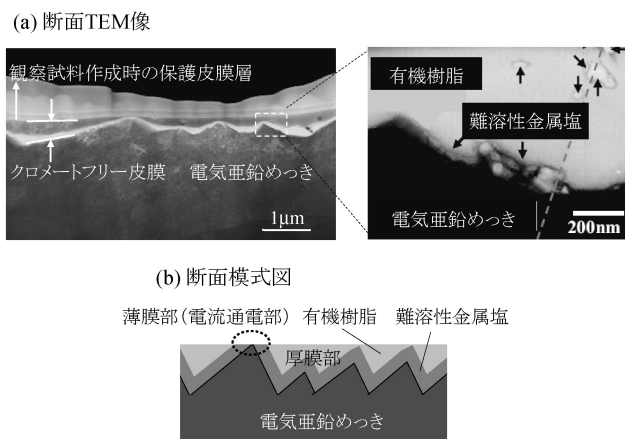
図1 従来クロメートフリー皮膜の断面構造。
