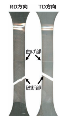
図6 曲げ-曲げ戻し引張試験での破断形態.
