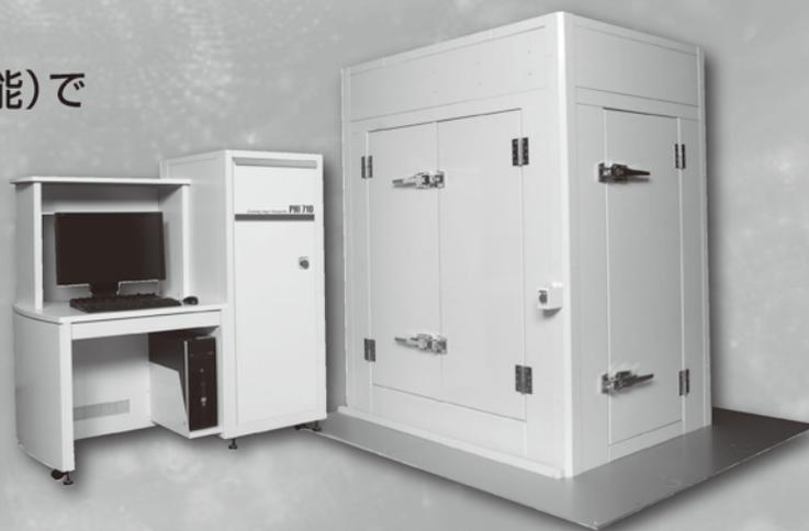
SEM 分解能  $\leq 3$  nm, AES 分解能  $\leq 8$  nm
