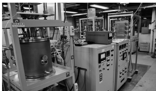
図2 高温酸化物および金属融体の物理化学的性質の評価装置群：高温(～1,600℃)で溶融した酸化物や金属の粘性、密度、表面張力といった基本的な物性値は、金属やセラミックス、半導体といった無機材料の製造プロセスを最適化する上で必要不可欠なデータベースである。これらの測定装置群を有している学科は世界的にも稀有であり、常に最新のデータを発信し続けている。
