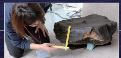
房総沖で採取されたコバルトリッチクラストは、厚さ13 cmで北西太平洋最大級であった。
