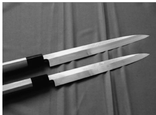
図4 FSP によって刃先の組織を微細化した調理包丁.
