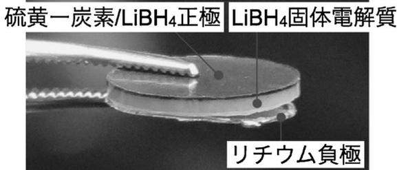
図2 作製したバルク型全固体リチウム硫黄電池の写真。セル構成を明確にするため、リチウム負極の一部を意図的にはく離している。AIP Publishing LLC より、許可を得て転載(2014)<sup>(26)</sup>。
