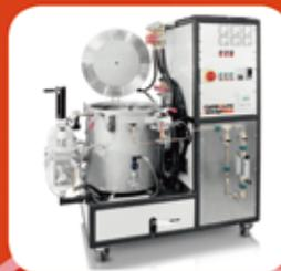
真空・加圧実験炉
