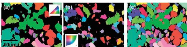
図3 日本刀にみられる非金属介在物の電子線後方散乱回折像, (a)  $\text{FeTiO}_3$  像, (b)  $\text{Fe}_2\text{SiO}_4$  像, (c) (a)と(b)を重ねた像<sup>(10)</sup>.
