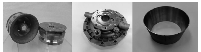
図7 工法置換による金属3Dプリンターの活用例。(国立研究開発法人 宇宙航空研究開発機構・株式会社由紀精密・株式会社コイワイ提供)
