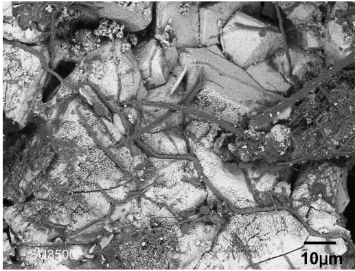
図1 高松塚古墳壁画の漆喰上に生じた黴の走査電子顕微鏡像(北田正弘).
