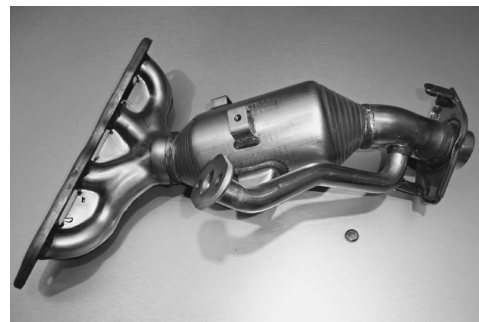
図8 開発鋼が使用されたエキゾーストマニホールド.
