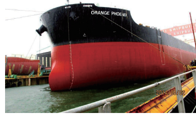
図3 NSafe®-Hull 初適用ばら積み船の進水.
