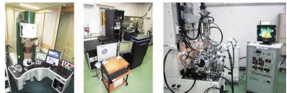
図31 照射済み材料のナノ組織観察を行う分析装置。収差補正透過電子顕微鏡(左)、レーザー補助3次元アトムプローブ(中)。アクチノイド化合物を製作するテトラアーク炉(右)。
