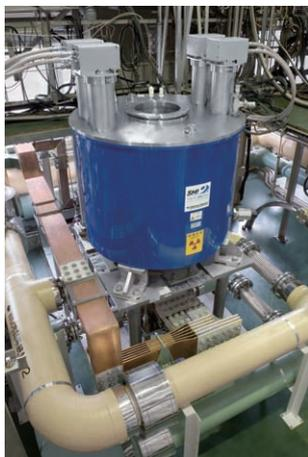
図33 32 mmの内径に28 Tの強磁場を発生する世界で唯一の無冷媒ハイブリッドマグネット。
