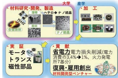
図38 NANOMET<sup>®</sup>の製造方法.
