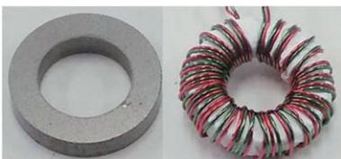
図29 コアの外観写真。(左)成形体、(右)製品体。
