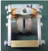
図5 X線自由電子レーザー回折装置用のスプリット型パルス強磁場磁石。
