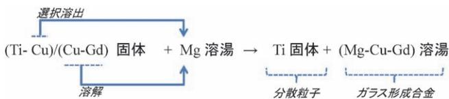
図2 Mg-Cu-Gd 系金属ガラスにチタン粒子がその場析出分散する反応設計の概念図<sup>(9)</sup>.
