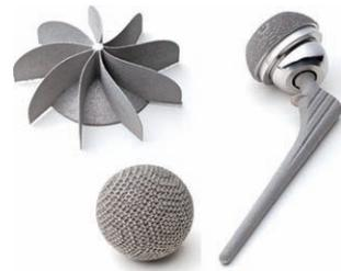
図25 EBM により作製した三次元金属造形物。
