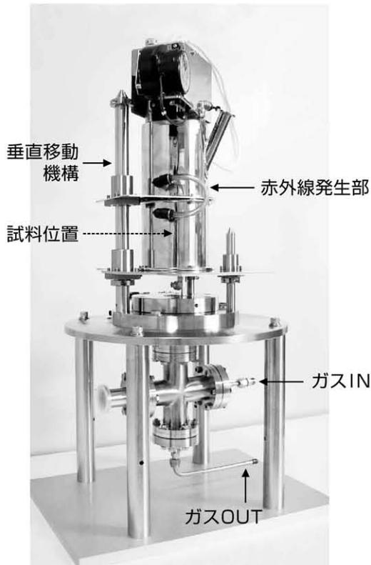
雰囲気ガスの流れは、炉心管の下部より上昇、試料表面をフローし、その後支持管内を通り、外へ流出します。試料は上方からの赤外線集光照射を受け短時間で超高温に到達します。
