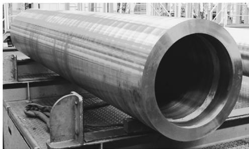
図10 試作したHR6W大径厚肉管の外観(外径635mm、肉厚72mm)。
