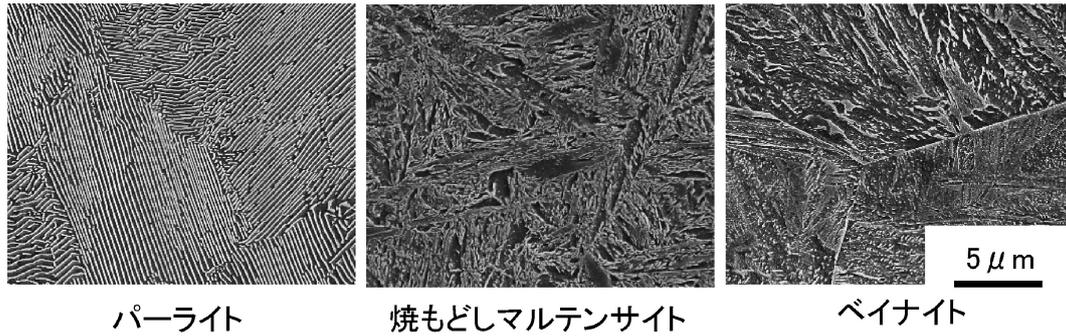
図2 摩耗試験に供したレール鋼のマイクロ組織.
