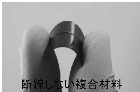
図4 ポリイミドフィルム上に導電性ポリマー/金属材料の配線パターンを形成し、曲げ戻しを繰り返した際の写真。
