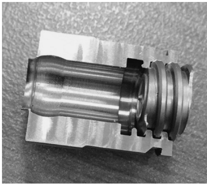
図8 ヘリカルフランジプラグの断面写真.
