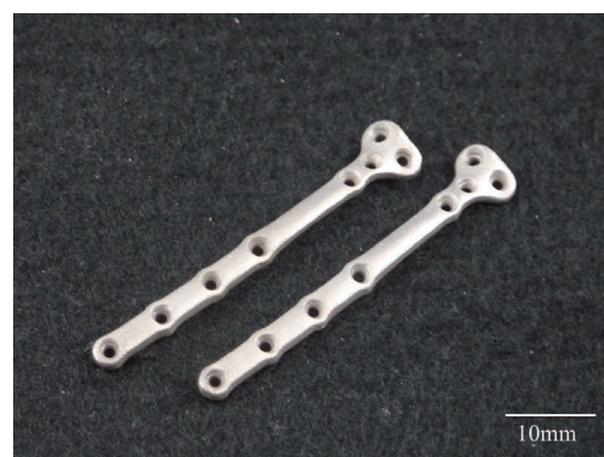
図2 三次元積層造形による実体化。
