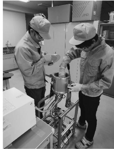
図1 高周波誘導溶解実験の様子。
