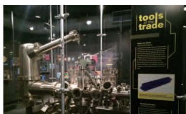
図2 シカゴ科学産業博物館に展示されている初期型のアトムプローブ電解イオン顕微鏡(Northwestern University からの寄贈)。
