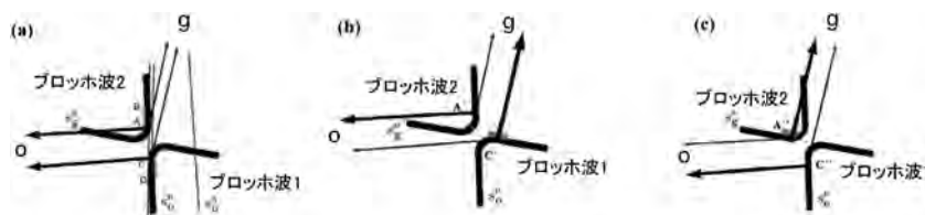
図 5 (a) 結晶に歪みが無く g = \bar{1}\bar{1}28 がブラッグ条件を満たしている場合の分散面、発散点、ブロッホ波の励起の状態。(b) Si コア基底面刃状転位の回りの歪み場。ブロッホ波 1 の励起が大きくなると推察される。(c) Si コア基底面刃状転位の回りの歪み場。ブロッホ波 2 の励起が大きくなると考えられる (6) 。
