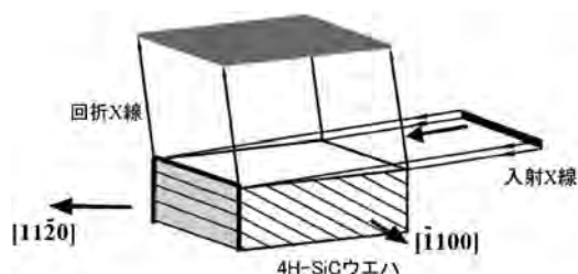
図 1 放射光を利用したベルク・バレット法の実験の配置図。
