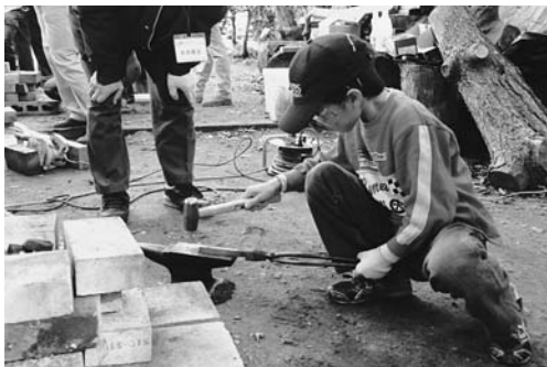
図7 鍛錬によるペーパーナイフづくり。熱した鉄片を叩いて伸ばし、ナイフの形に成型する(第3回子どもたたら教室より)。
