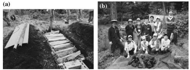
図3 (a)伏せ焼き法の基本構造。(b)完成した木炭と一緒に記念撮影(ともに第3回子どもたたら教室より)。
