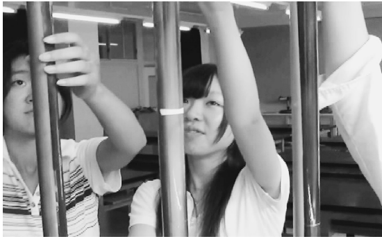
図1 金属管内を落下するネオジウム磁石の速さの比較. 金属管に磁気テープを貼り、磁石の位置を確認する。
