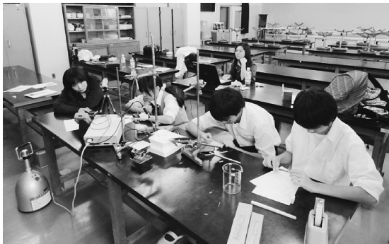
図3 電気抵抗実験。装置の表示をビデオで撮影し、温度と電気抵抗をリンクさせるとともに、読み取りの間違いを防いだ。
