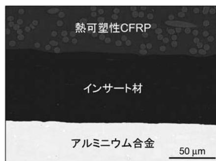
図6 熱可塑性CFRP-インサート材-アルミニウム合金接合品の断面反射電子像。
