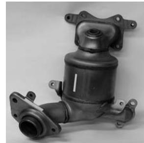
図10 開発鋼 JFE-TF1 が使用されたコンバータケース.
