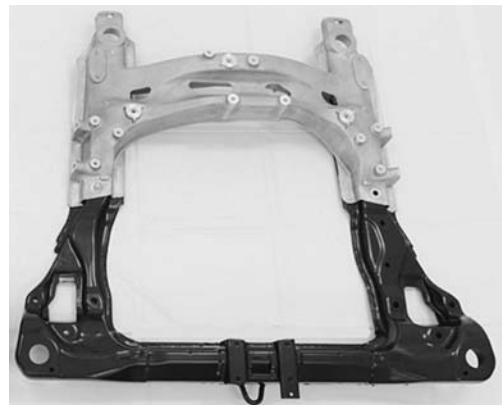
図8 高真空ダイカストで製造した部品と高張力鋼のプレス品を摩擦攪拌により接合したサブフレーム(本田技術研究所提供)。
