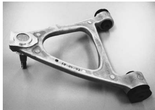
図 4 半凝固ダイカスト法で生産したアッパーアーム(日立金属提供)。
