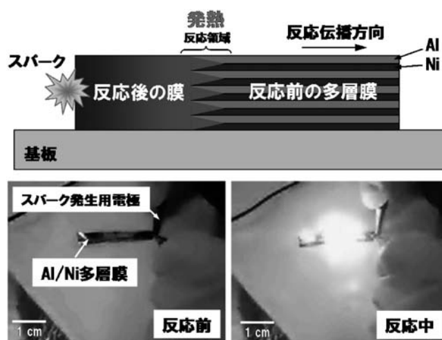
図1 自己伝播発熱多層膜と反応例。
