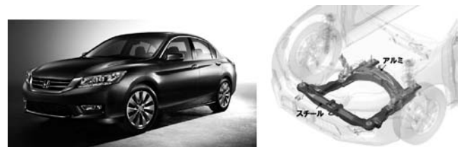
図 7 アコードとフロントサブフレーム。
