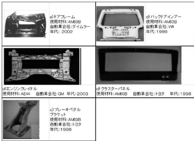
図10 車体・シャーシへのマグネシウム合金の適用事例。
