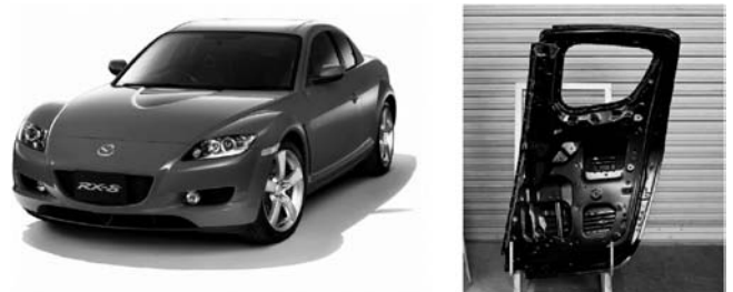
図3 FSSW(SFW)を採用したRX-8とリアドア。
