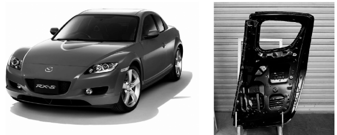
図3 FSSW(SFW)を採用したRX-8とリアドア。
