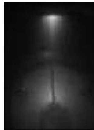
図 1 Penning 型イオン源から得られる直径約 3 mm の Ar イオン束。中間部分に試料を設置し照射する。
