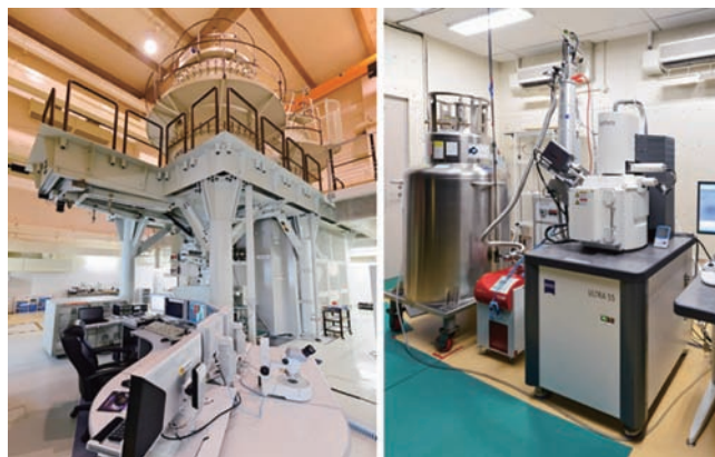
図1 九州大学に設置されているオメガ型電子エネルギーフィルターを内蔵した超高压電子顕微鏡 JEM-1300NEF(左)と超伝導マイクロカロリメーター XEDS を装着した走査電子顕微鏡 ULTRA55(右)。
