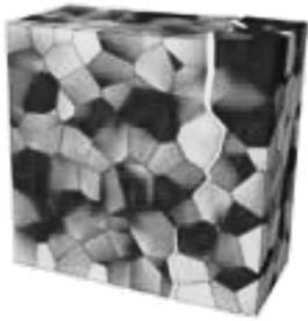
図4 多面体粒子モデルによる高温亀裂発生シミュレーション例 (38) .
