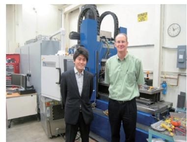
図3 ブリガムヤング大学にある摩擦攪拌接合機。Tracy W. Nelson 教授(右), 筆者(左)
