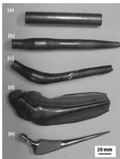
図4 冷間加工，機械加工によるステム製造工程．
