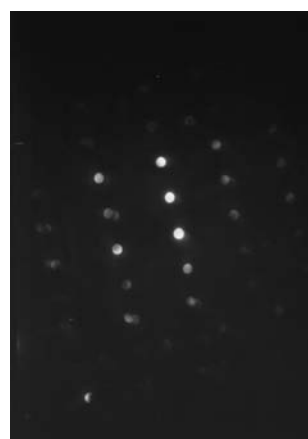
図4 析出物の電子回折像([1120]入射)。
