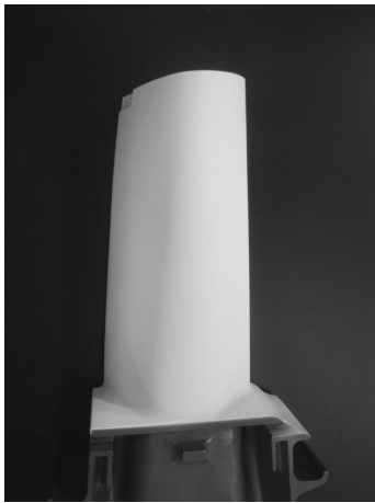
図9 YSZ コーティング発電用第一段動翼.
