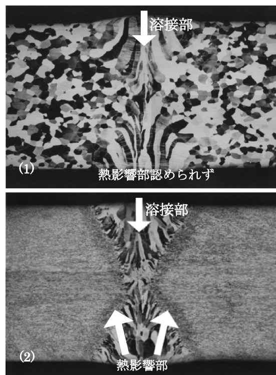
図13 TIG 溶接部の断面組織 (1) 高純度 Fe-18Cr 合金および (2) 汎用 SUS430。
