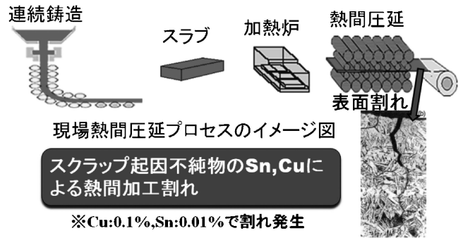
図4 熱間圧延プロセスのイメージ図と普通鋼で発生する表面赤熱脆性。
